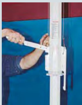
2. Retendre à gauche: Insérer l'étrier et rabattre le levier de tension vers le bas. De cette façon l'EVENT est ouvert.
