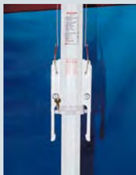
3. Fermer les leviers: Introduire les serrures dans les deux leviers, fermer, retirer les clés. – voir instructions illustrées # E-01/12.
